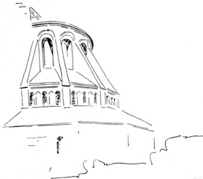
Рис. 52. Древние контфорсы являются перевернутыми V-образными опорами
