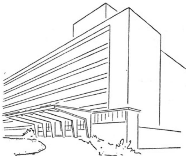
▼ Рис. 83. V-образная стойка с консолью четко отделена от основного сооружения. Структура при данном решении ясна
