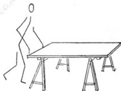
Рис. 56. 1. V-образная форма ножек стола и стула соответствует нарастанию усилий, которые являются наибольшими вверх в местах крепления ножек
