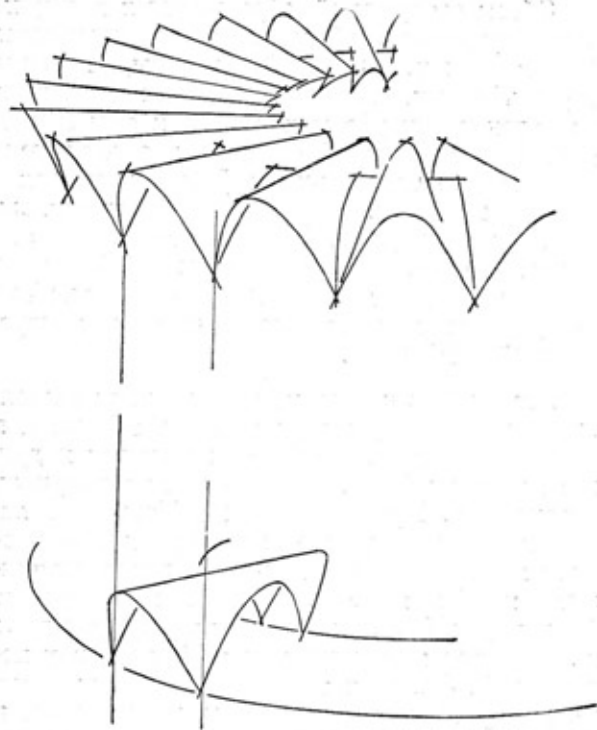
Рис. 158. При сложных пересечениях оболочек приходится отказаться от чистой цилиндрической формы. Эскиз аэропорта
