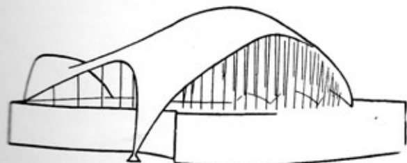
Рис. 192. Клуб Тахира в Южной Америке. Инж. Торроха. Произвольная форма может быть конструктивно оправдана
