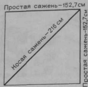
1.2 Древние русские меры длины и плот- ничий наугольник 1.3 Окладывание сруба
