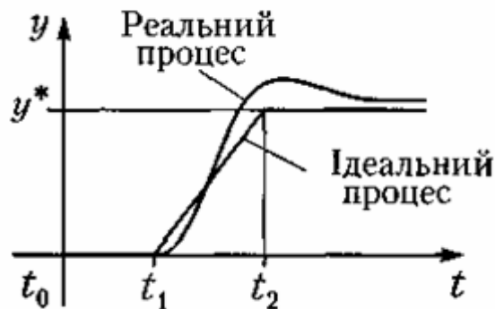
Рис. 1.23. Процеси у системі управління положенням кінематичного механізму (КМ)
